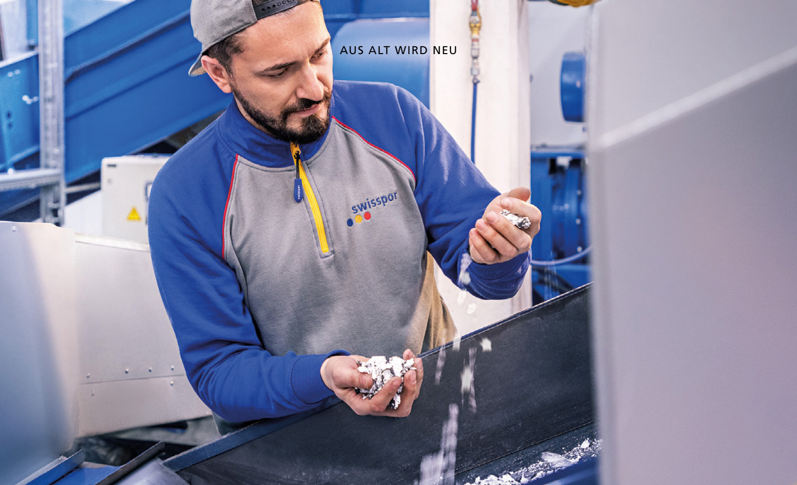
Simon Gjokaj, Abteilungsleiter EPS-Recycling, prüft die Qualität des zerkleinerten Sekundärrohstoffes.
