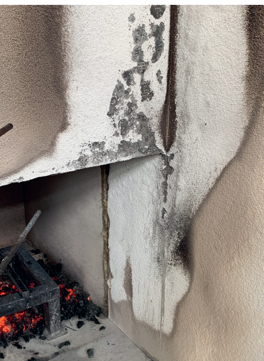
Unbeschädigte Sturzausbildung nach Grossbrandversuch.
