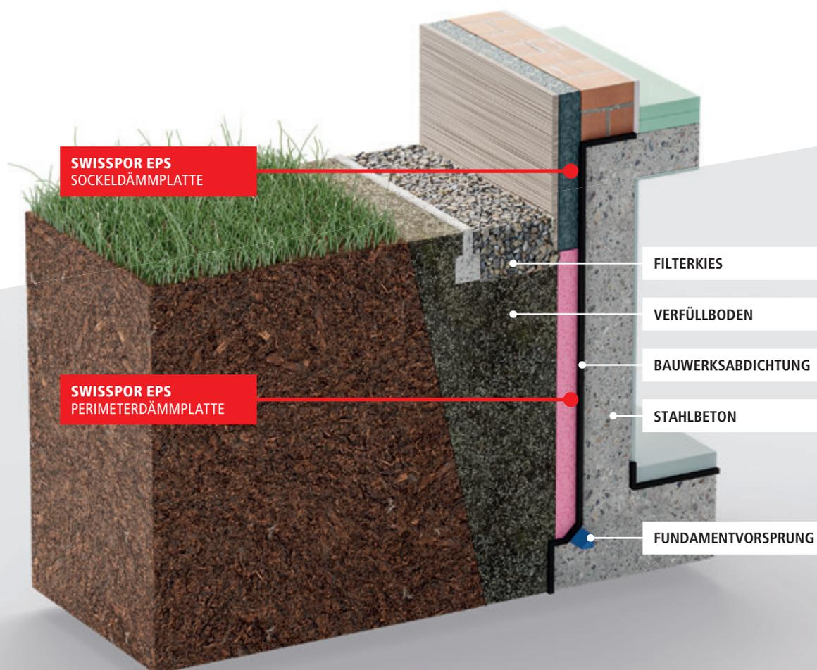
Gemäß Zulassung werden sowohl WDV **Sockeldämmplatten**, als auch **Perimeterdämmplatten**, im horizontalen und vertikalen erdberührten Bereich als Wärmedämmung außerhalb der Gebäudeabdichtung eingesetzt.
